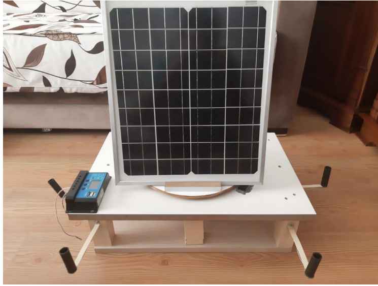
Şekil 2. Güneş Takip Sistemi
