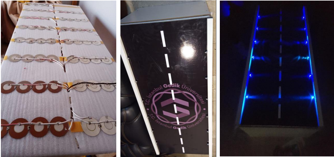
Şekil 1. Elektrik Üreten Akıllı Yol
